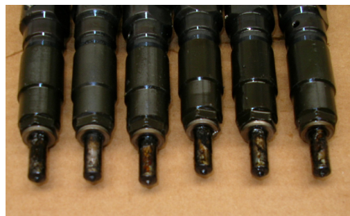
Abb. 2: Verkockungen an Einspritzdüsen im Sojaölbetrieb
