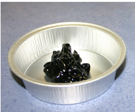
Abb. 4: Eingedicktes Schmieröl nach Sojaölschaden
